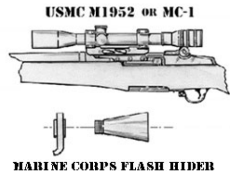
L'attacco dell'ottica 4x dell'MC-1 e lo
